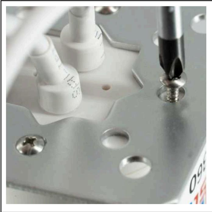
2. Conecte los amarres al soporte de la antena y fije la antena al mástil.
