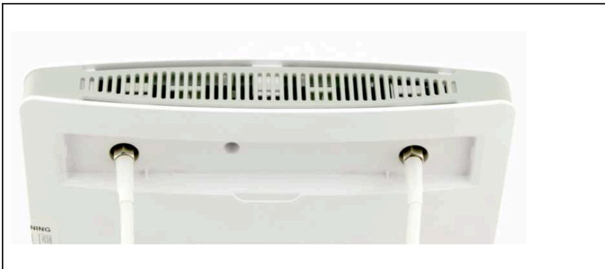
**IMPORTANTE:** En algunos modelos de Router 4G (Huawei) y routers proporcionados por las compañías de telefonía móvil necesitaremos configurar el router para que utilice la antena externa en lugar de la antena interna integrada.
